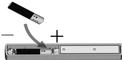
**Batterie in Halterung einsetzen.**
